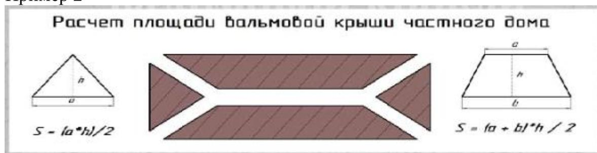
Трапециевидные скаты имеют следующие параметры: одна сторона 10 м, другая 7 м, высота 3 м. Треугольные скаты: две стороны по 3,34 м, одна сторона 7 м. Высота треугольника 4,8 м.
